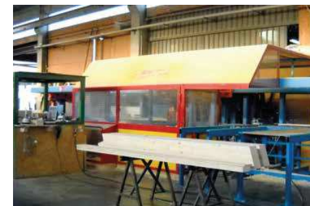
La sede di Zini Dino, a Castelnovo ne' Monti. A destra, la macchina per il taglio del legno a controllo numerico
